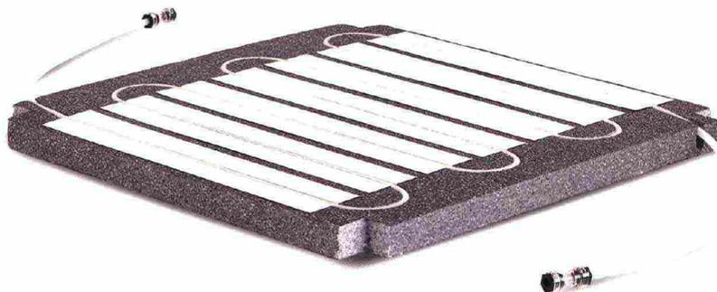
Sviluppato da Newfloor, Radiafloor combina il pavimento sopraelevato con il sistema radiante di riscaldamento e raffreddamento. Il modulo è costituito da materiale termoisolante in polistirene estruso, caricato di grafite per migliorare le performance, all'interno del quale è inserita una serpentina passante con interasse costante, e da una piastra di diffusione termica in alluminio. L'installazione di Radiafloor avviene a secco e permette l'ispezionabilità degli alloggiamenti sottopavimento
